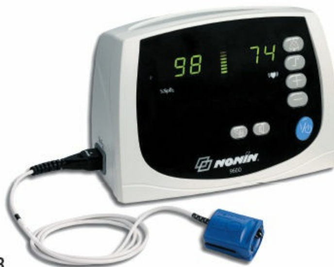
Figura 20-12 • La medición de la oxigenación de la sangre con oximetría de pulso reduce la necesidad de procedimientos invasivos, como extracción de sangre para análisis de la concentración de oxígeno. A. Oxímetro de pulso digital en la punta del dedo, que incorpora el sensor y la pantalla en una unidad. B. Modelo de mesa con sensor conectado. La memoria permite el seguimiento de la frecuencia cardíaca y la saturación de oxígeno en el tiempo.
