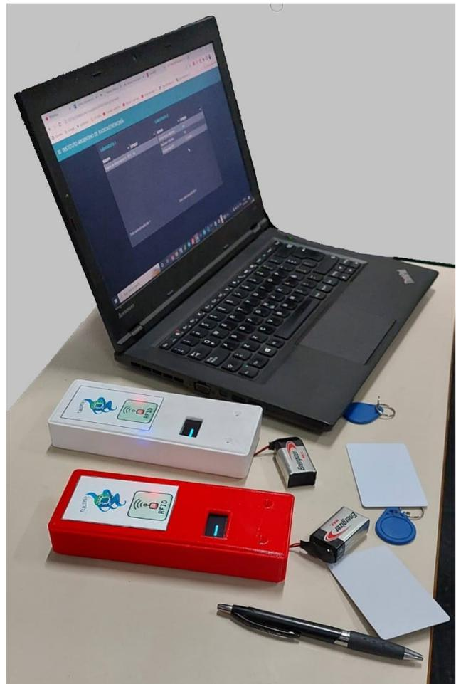
Fig. 5: Terminal montada y funcionando junto con el servidor. (Etapa de prototipo)
