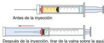
Figura 35-27 ■ Dispositivo de seguridad activo. El profesional de enfermería tira con la mano de la vaina o cubierta sobre la aguja después de la inyección.
